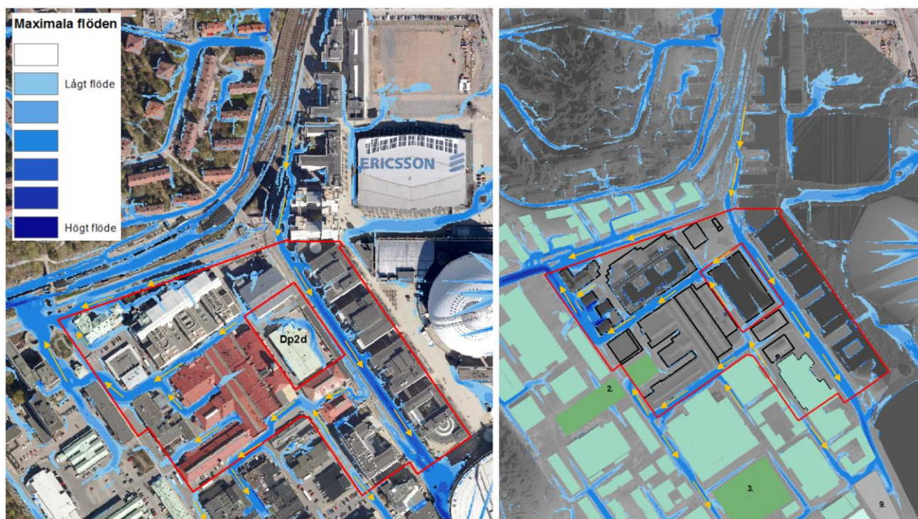
Figur 17 Beräknade maximala flöden (blåa fält), till vänster befintligt och till höger vid ny exploatering. Gula pilar visar flödesriktningen, röd polygon plangränsen, svarta rutor visar byggnader inom Dp2, turkosa polygoner byggnader utanför Dp2 gröna och gråa polygoner visar läge för skyfallsåtgärder (parker/torg).
