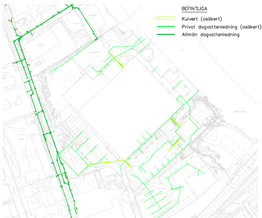
Befintliga dagvattenledningar på och runt fastigheten Gjutmästaren 6.
