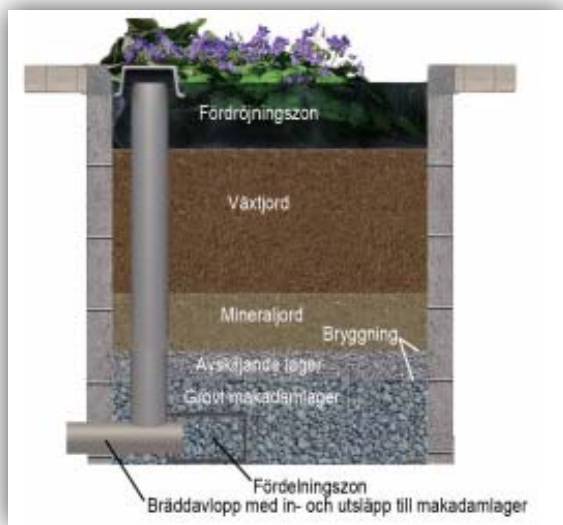
Bild 11. Exempel på uppbyggnad av regnbädd med tjockt lager växtjord för att möjliggöra plantering av träd. Vid hög vattenbelastning bräddas vatten ut i kupolbrun (Movium 2015).
