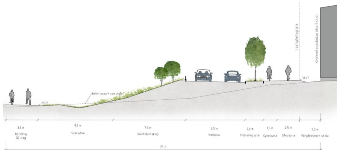
Figur 11. Principskiss över föreslagen utformning av gata och GC-bana i södra delen av området med dike på båda sidor om GC-banan på södra sidan om gatan och skelettjord mellan gata och GC-bana på norra sidan (Tyrens, 2020).
