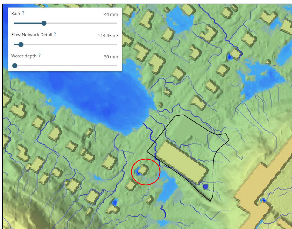
Figur 25. Översvämningssanalys i SCALGO för planerad situation vid ett 44 mm regn (motsvarar 100-årsregn). Planområdet är markerad med svart linje. Fastighet sydväst om planområdet som riskerar att översvämmas är markerad med röd cirkel.
