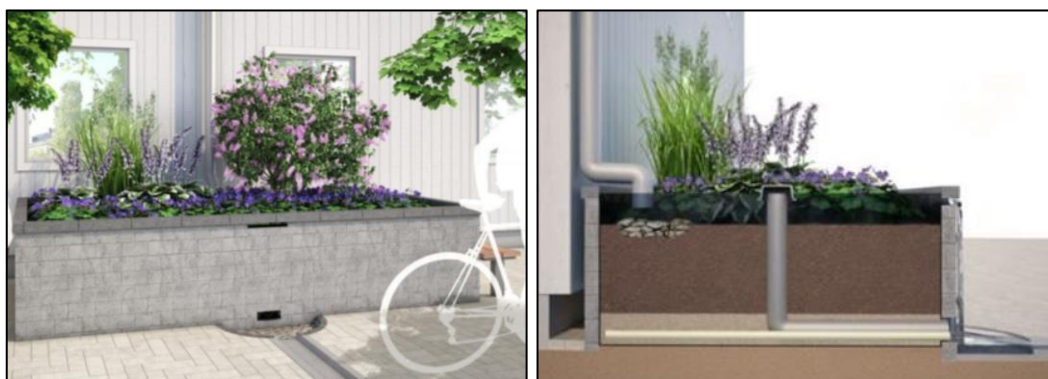
Figur 21 & 22. Exempel på upphöjd växtbädd som tar emot dagvatten från tak via stuprör (Vinnova, 2014).
