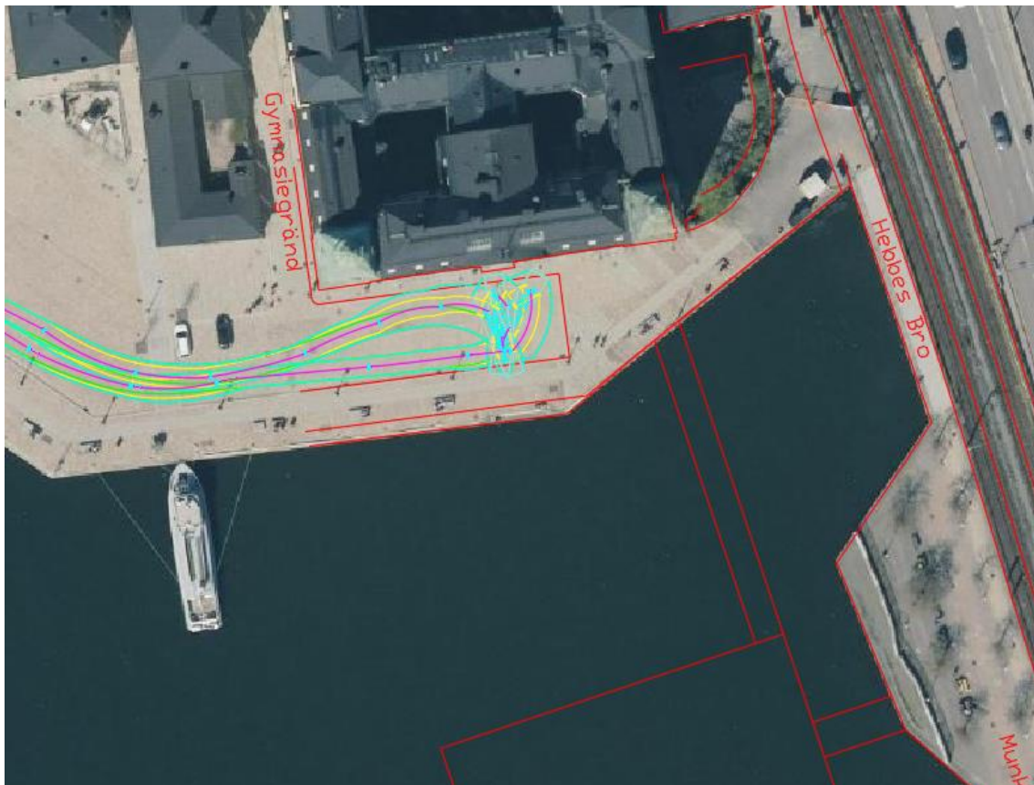
Figur 10: Körspår för backvändning med lastbil vid befintlig vändyta/gatans slut
