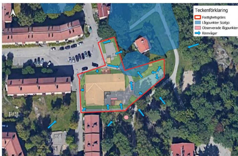
Markerade lågpunkter inom fastigheten. Blå pilar markera flödesriktningar. (Geosigma, 2021).
