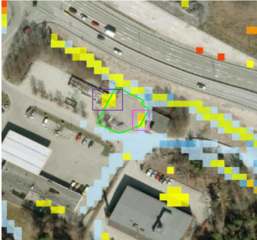
Figur 10. Bild från Stockholms stads skyfalls modell med de två riskområdena markerade i lila och rosa. Blått visar vattnets flödesvägar över området, Röd-gula färger visar på hur djupt vatten som kan ansamlas i vattenvägar och lågpunkter vid 100 års regn med klimatfaktor. Fastighetsgränsen är markerad med grön linje.
