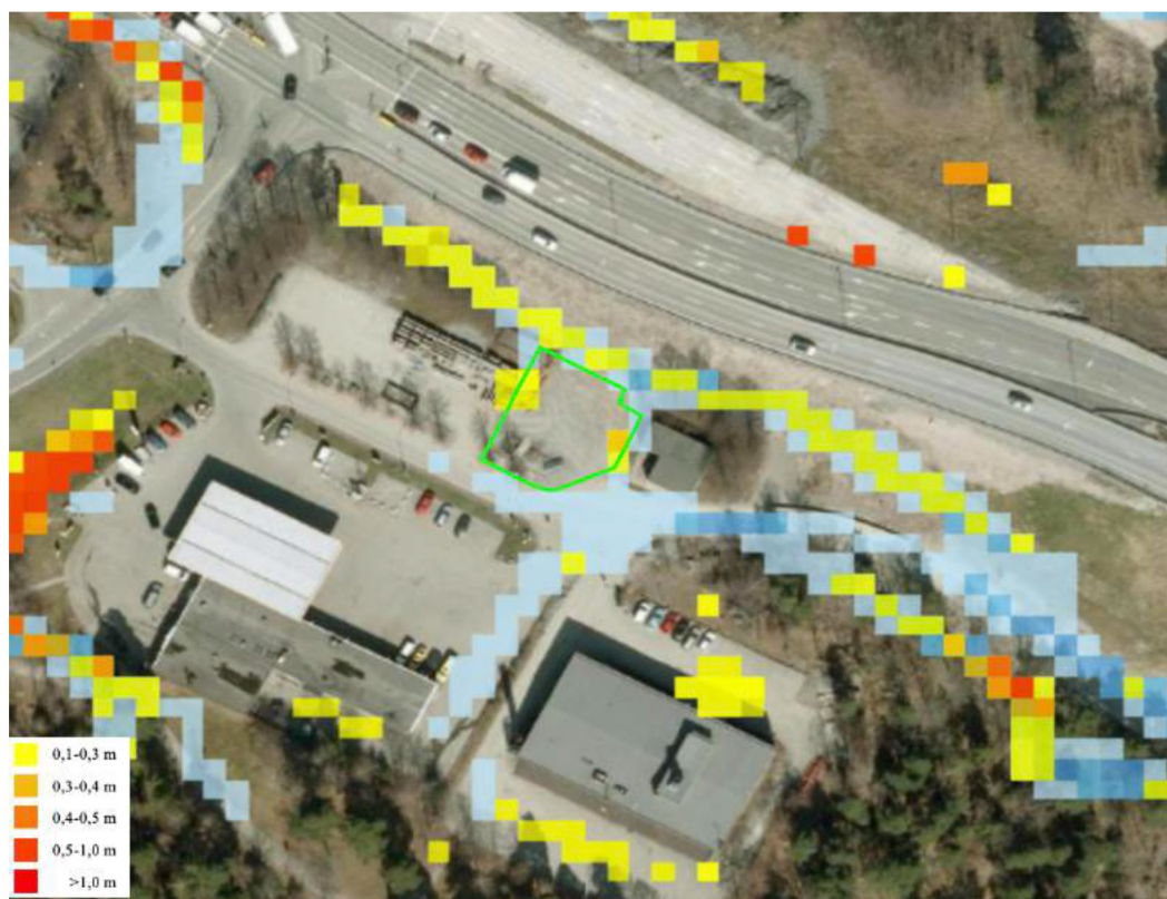
Figur 9. Bild från Stockholms stads skyfallsmodell. Blått visar vattnets flödesvägar över området, Röd-gula färger visar på hur djupt vatten som kan ansamlas i vattenvägar och lågpunkter vid 100 års regn med klimatfaktor. Fastighetsgränsen är markerad med grön linje.
