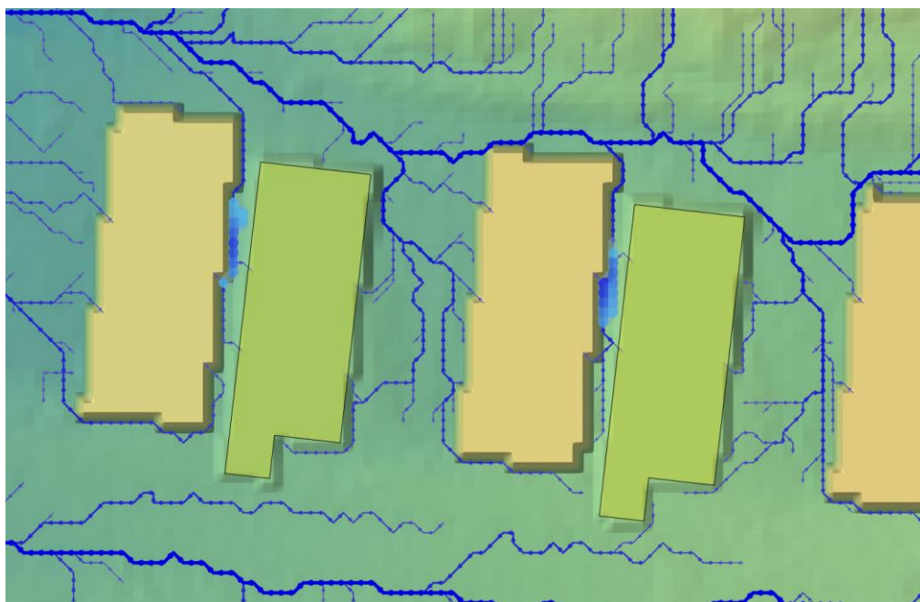
Figur 26 Skyfallssituationen påverkas inte negativt vid eventuell markhöjning för parkeringsplatser och resulterar inte i stående vatten på grönyrtorna
