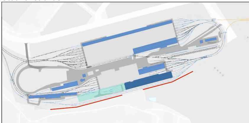
Föreslagna stödkonstruktioner markerade med rött. Den planerade städ- och uppställningshallen är markerad i mörkblått. Turkos markering avser en eventuell utökning av byggnaden vid behov. (WSP, 2020)
