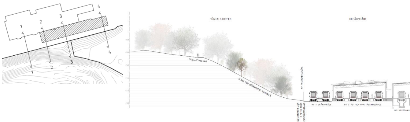
Sektion 2 med snitt mellan de två sponterna och relation mellan Högdalstoppen och tillkommande städ- och uppställningshall inom depåområdet. (Ahnborg Arkitekter, 2020)
