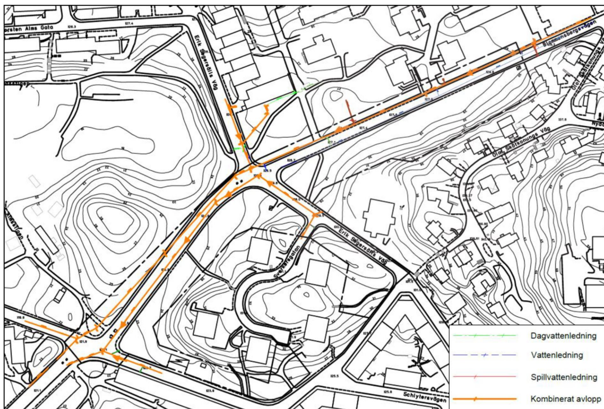
Figur 11. Befintligt ledningsnät inom planområdet med pilar som visar det kombinerade avloppets flödesriktning.
