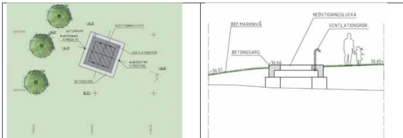
Figur 13. Vänster: Utformning av utrymningsschakt Västberga i plan. Höger: Utformning av utrymningsschakt Västberga i sektion.
