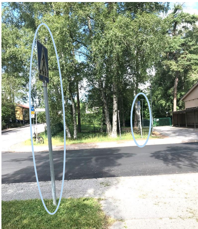
Figur 7 Övergångsställe över Abrahamsbergsvägen. Övergångsstället är omålat och stolparna med vägmärken är inte parallellt placerade. Fotot är taget från Geografiboken ut mot Abrahamsbergsvägen.
