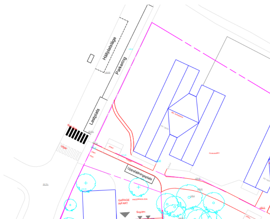
Figur 15. Abrahamsbergsvägen får ny utformning när utfarten till Geografiboken flyttas. Här är ett exempel på placering av övergångsställe, hållplatsläge och lastplats.
