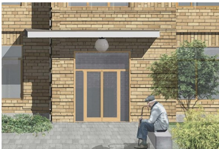
Vy från korsningen mellan Västerled och Abrahamsbergsvägen. Byggnaden bör ha en tunn utstickande takfot. Sockeln ska markeras i fasad. Sockel föreslås markeras med tegeldetaljer, murning som skiljer sig från den övriga fasadens murning samt markering kring fönster. Byggnaden har en generell variation i teglets bränning/färg. (Åwl arkitekter).
