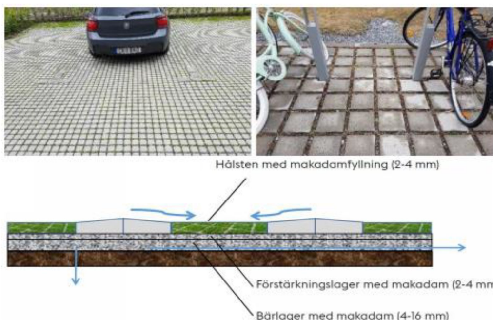
Figur 22. Beläggningen fungerar som underlag för såväl bil- som cykelparkering. Längst ner i bild visas en principskiss över anläggningens rekommenderade uppbyggnad (Illustration: WRS).
