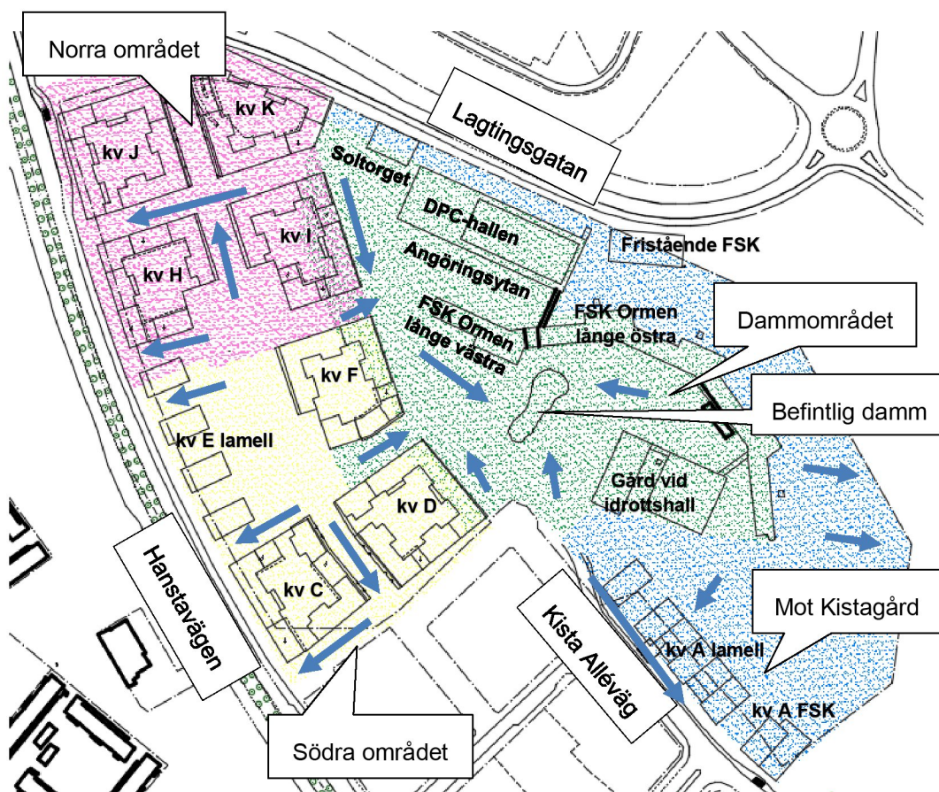
Figur 15. Delavrinningsområden efter exploatering av kv Odde. Pilarna visar riktning från delavrinningsområdet mot förbindelsepunkt till dagvattennätet.
