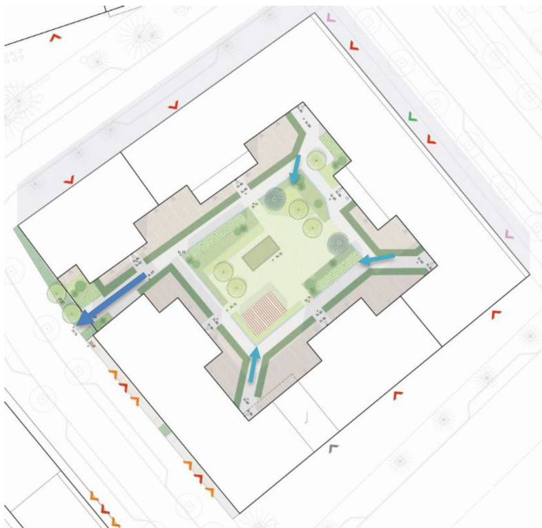
Figur 17. Blå pil visar sekundär avrinningsväg för dagvatten vid extrem nederbörd inom typkvarter.
