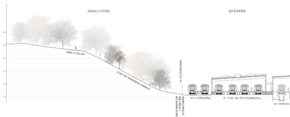
Sektion 1 med snitt genom västra sponten och relation mellan Högdalstoppen och nytt spår område inom Högdalsdepån.
