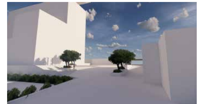
Bild 2: Gångstråket håller en jämn lutning ängs fasaden, (ca 7,5%) avskild från körytan av en långsträckt plantering i planteringslådor/stödmurar.
