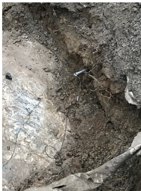
Figur 2 (vänster) provgropen med tågspåren i bakgrunden. (höger) gropen där accelerometrarna fästes på berg samt i den lösa marken med hjälp av ett spett.
