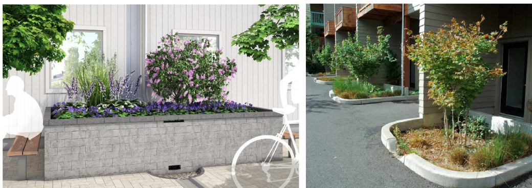
Figur 6 Exempel på växtbäddar för dagvattenhantering tak.
