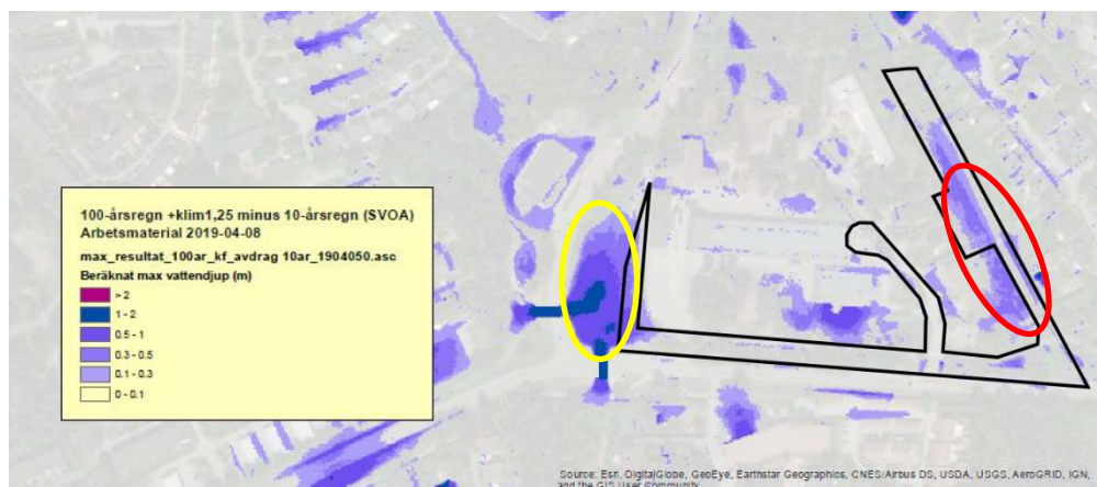
Figur 7. Modelleringsresultat för 100-årsregn med klimatkorrektur 1,25 samt avdrag av ett 10-årsregn på grund av avledning i ledningsnät. Ungefärlig utredningsområdesgräns är markerad med svart. Källa: Arbetsmaterial Ramboll, 2019.
