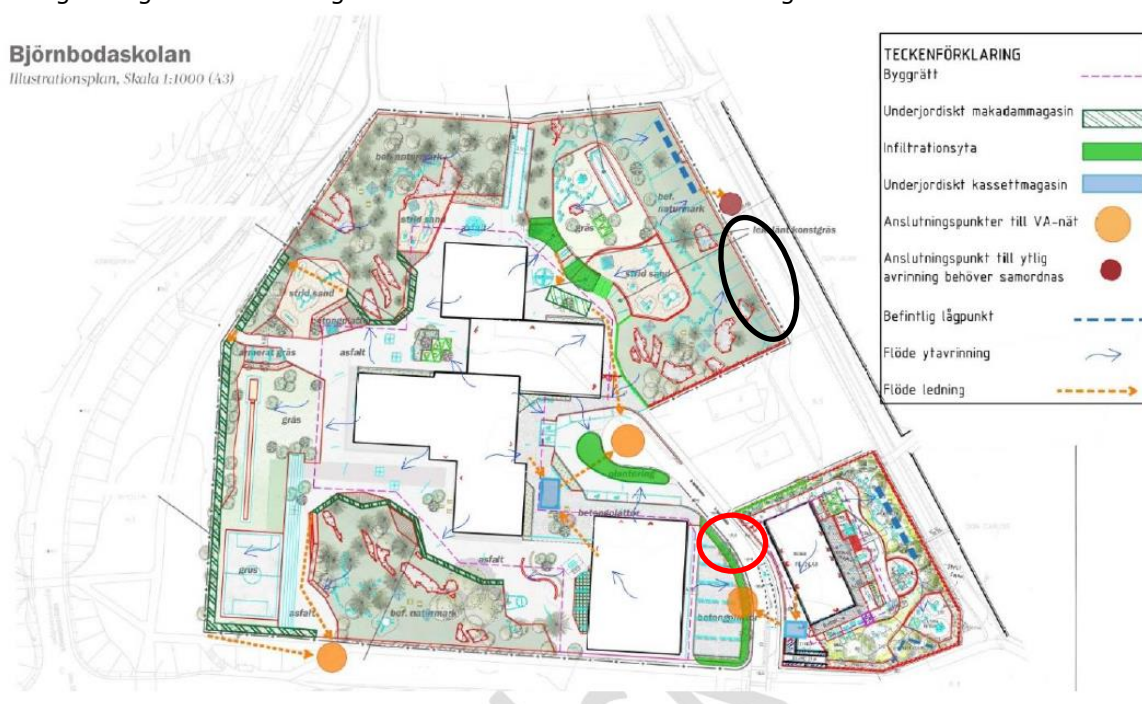
Figur 8. Planerade rinnstråk och dagvattenhantering inom kvartersmarken (Geosigma, 2019). Svart ring markerar rinnstråk från kvartersmark som avvattnas
