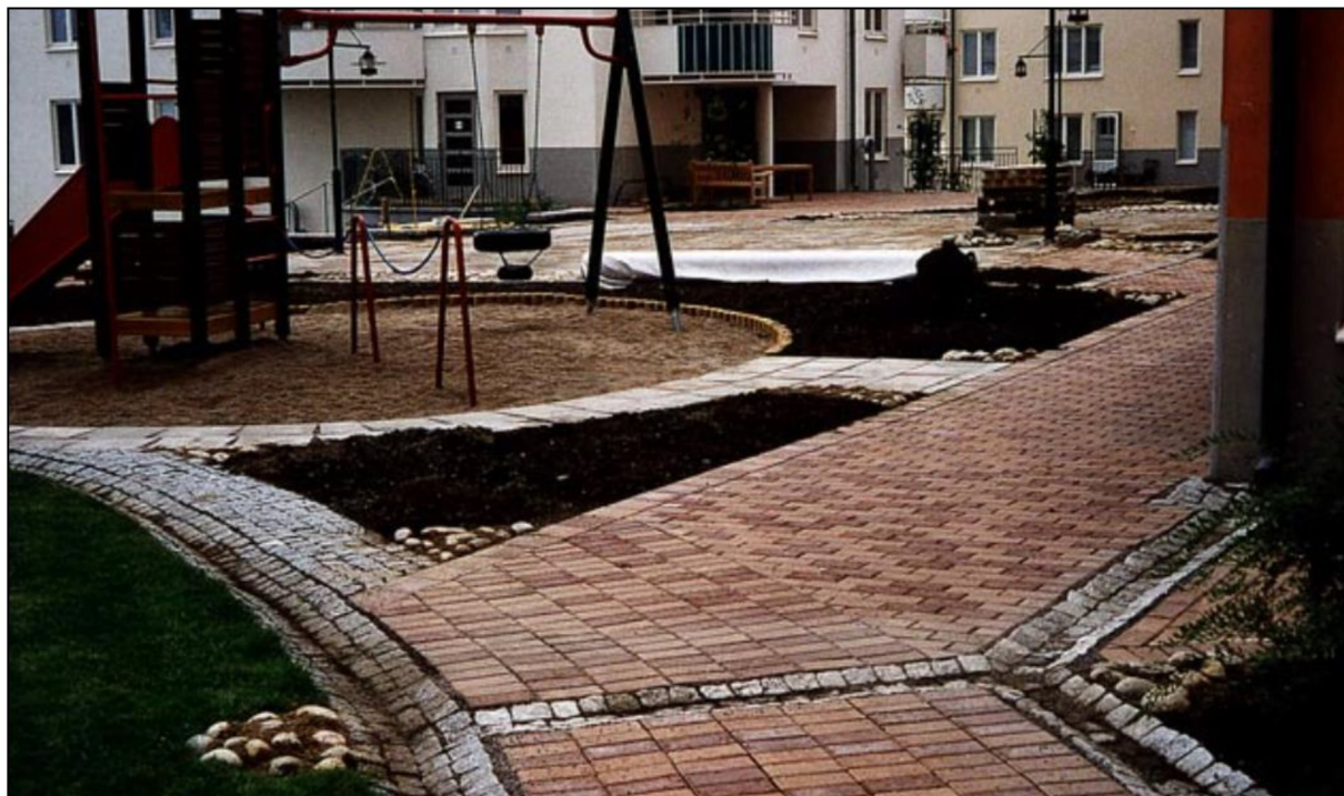
Figur 6-2. Exempel på avledning av takvatten via rännदार anlagda med gatsten (Källa: Stockholm Vatten AB, n.d.).
