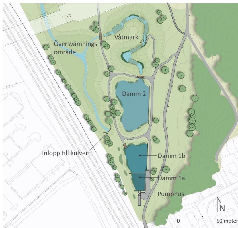
Utsnitt ur illustrationsplan med planerade dagvattenanläggningar (Ramboll, 2021).
