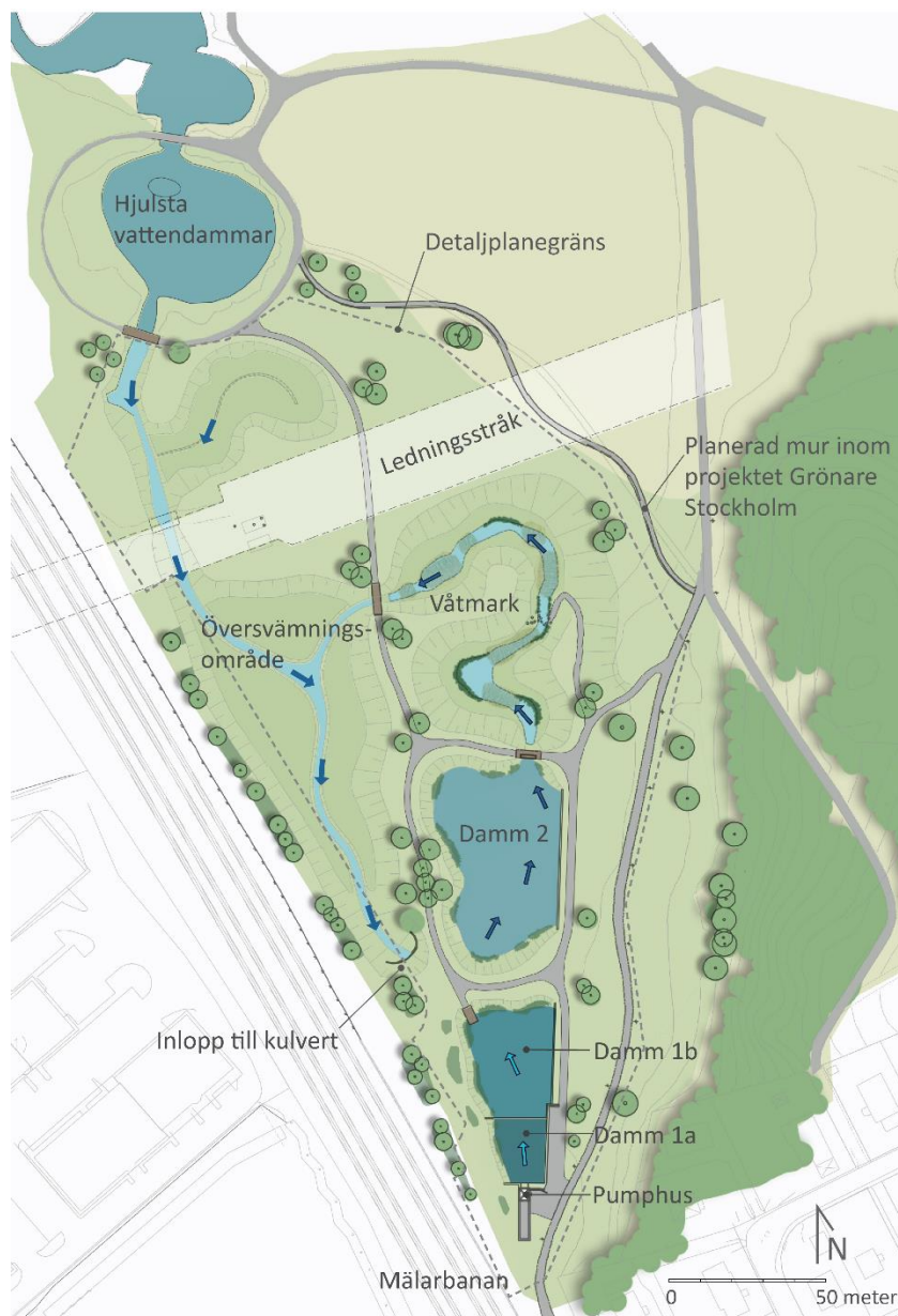
Möjlig utformning av dammar och översvämningsyta. Pilarna visar vattnets flödesriktning (Ramboll).
