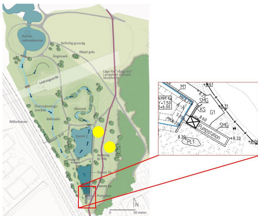
Illustration över föreslaget gång- och cykelstråk samt uppställningsplats och vändyta för driftsfordon. Gula markeringar är föreslagna alternativ för placering av geotuber vid muddring av dammarna.
