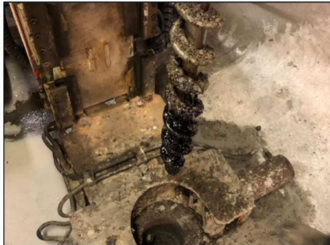
Figur 5. Provpunkt 19GS12, nivå 1,0-2,0 m. Trögflytande olja och stark lukt av olja. Materialet var liknande mellan 0,6 m och 3,4 m under golvnivå.
