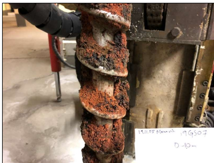
Figur 3. Provtagning vid punkt 19GS07, nivå 0-1,0 m. Fyllningsmaterial bestående av krossat tegel med klumpar av trögflytande olja.
