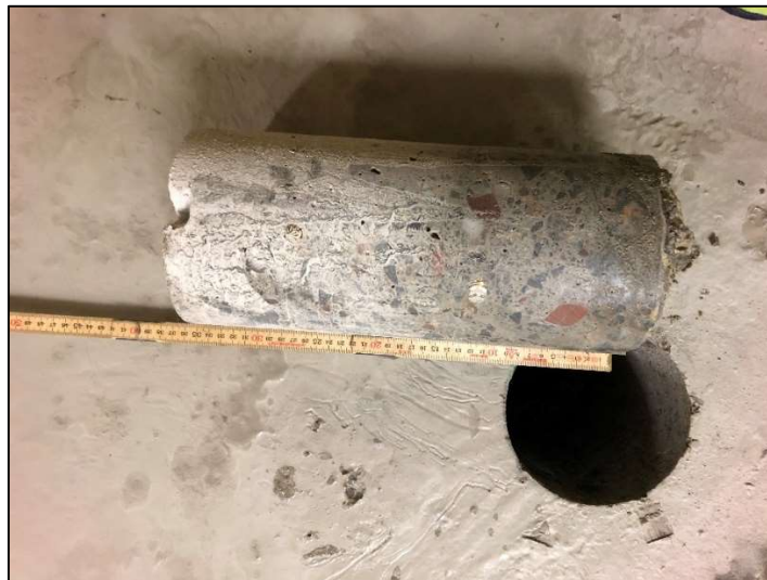
Figur 2. Innan provtagning i garaget togs hål i betonggolvet med en betonghåltagare. Betongens tjocklek varierade mellan 14 och 36 cm.
