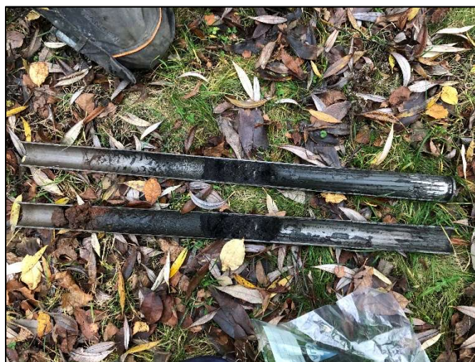
Figur 9. Provtagning med mullvad i 19GS01 mellan 5,5 och 7,0 m under markytan. I provet observerades tegelbitar, svart fyllningsmaterial och bedömt naturlig lera.
