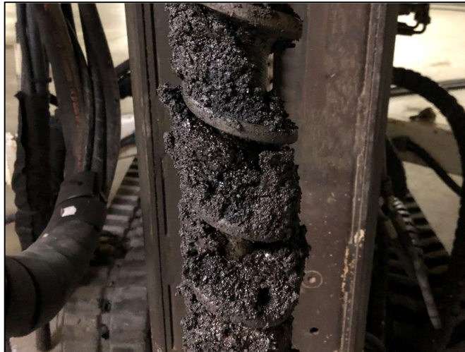
Figur 7. Närbild från punkt 19GS16 under kallgaraget. Jorden var svart av olja.
