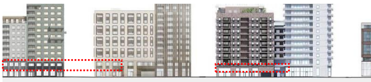
Fasadelevation mot Årstaängsvägen, sammanhållen gestaltning med tvåvånings sockelmotiv (f7).
