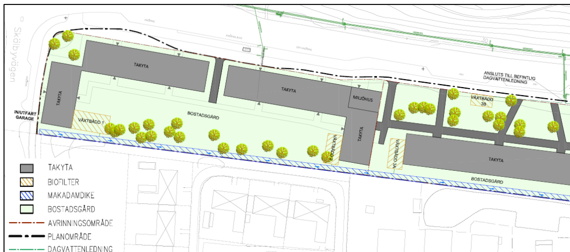
Figur 11 Förslag på dagvattenåtgärder i södra planområdet. Blått skrafferat område visar föreslaget makadamdike med rinnpipor (se hela planområdet i Bilaga 1).
