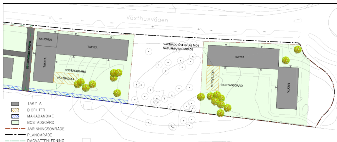
Figur 12 Förslag på dagvattenåtgärder i norra planområdet. Blått skrafferat område visar föreslaget makadamdike med rinnpipor (se hela planområdet i Bilaga 1).
