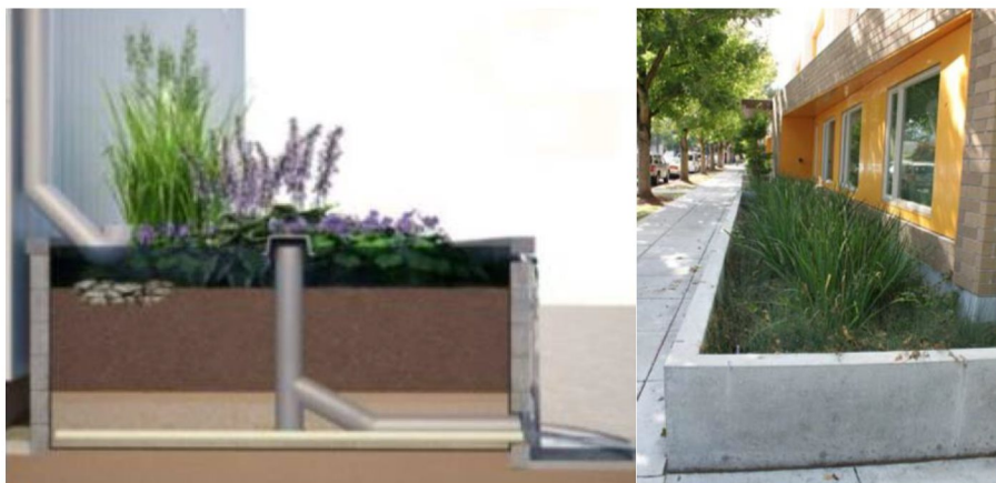
Figur 1. Principskiss och exempel på fördröjning av takvatten i upphöjd växtbädd.
