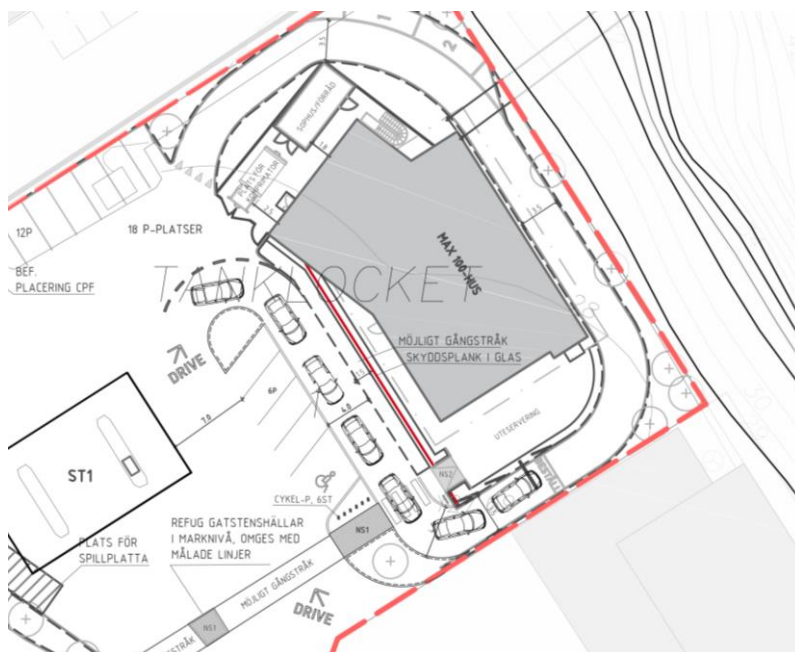
Föreslaget drive-in-system där erforderligt kömagasin kan hanteras på platsen.
