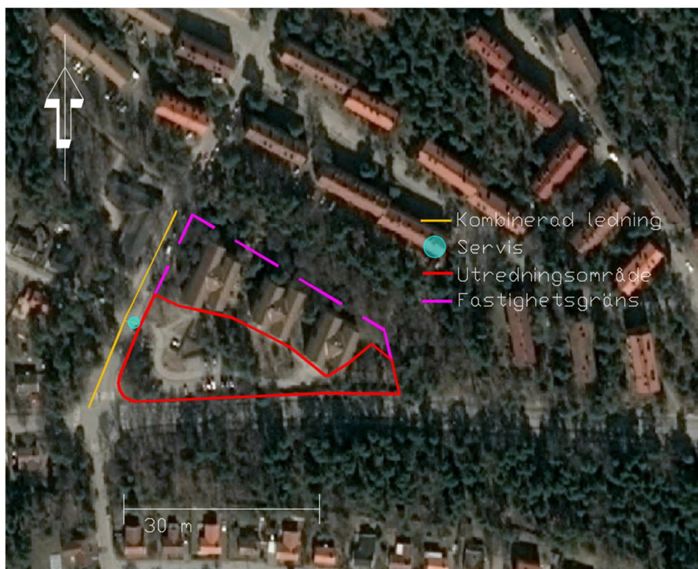
Figur 4. Servisanslutning vid fastighetsgräns som ansluter till kombinerad ledning med fall sydväst. Flygfotot ©2019MicrosoftCorporation ©2019DigitalGlobe.
