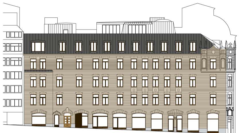
Fasadelevation mot Jakobsbergsgatan med rekonstruerad sockelvåning samt takpåbyggnader.
