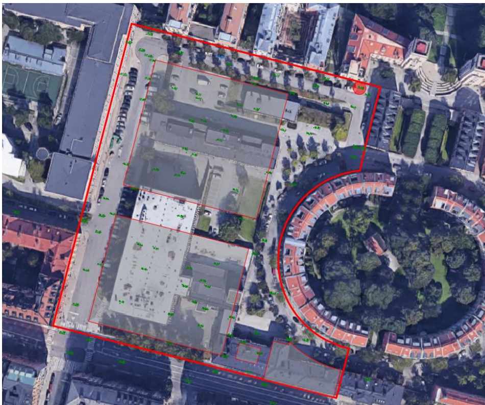
Figur 19 - Visuellt identifierad lågpunkt efter exploatering markerad med röd cirkel.
