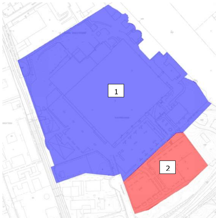
Figur 8. Uppskattade befintliga tekniska delavrinningsområden. Område 1 (blått) avvattnas norrut och område 2 (rött) avvattnas söderut.
