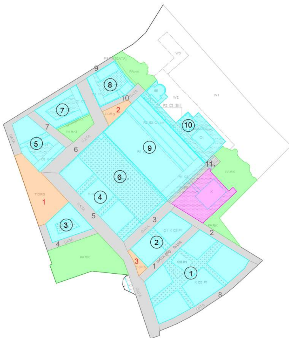
Figur 16. Uppdelning mellan kvartersmark (blå) och allmän platsmark (grå-gator, grön-parker och orange-torg/övrig allmän platsmark) samt befintlig kvarter som inte planeras byggas om (rosa).
