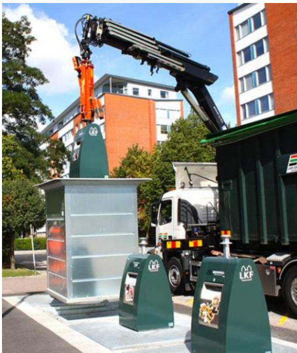
Figur 11 Underjordsbehållare – tömning med kranbil. Källa: Sansac
