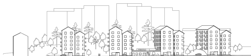
Fasadelevation längs Tavelsjövägen. Visar hur planförslaget fortsätter det gavelmotiv som det befintliga lamellhuset mot Årstavägen påbörjar längs Tavelsjövägens början. De nya husen är rytmiskt placerade längs gatan med mellanrum mellan husen vilka utgörs av bevarad naturmark och i mitten en garagebyggnad i en våning med bostadsgård ovanpå. (Arkitektstudio Witte)
