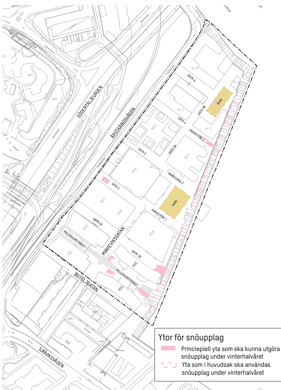
Figur 12: Illustration över principiella ytor för snöupplag (ytor fastställs i systemhandlingen).
