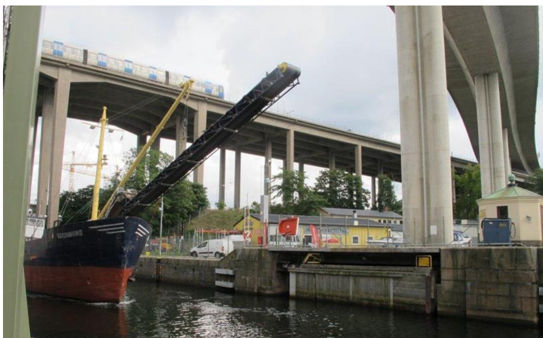
Figur 26. Fartyget Nordanvind (L 45m, B 6m, T 2,9m, lastkapacitet 350 ton) med ett utskjutande transportband. (foto B Forsman).
