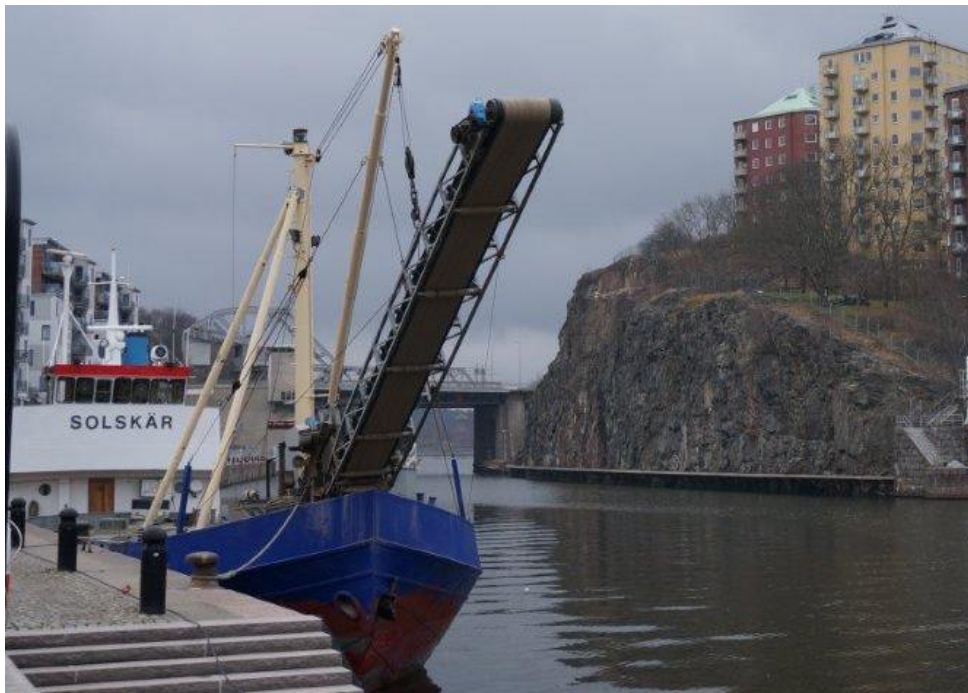
Figur 31. Fartyget Solskär vid N Hammarbykajen (Längd 38 m) med ett utskjutande matarband i fören. (foto: A. Bakosch)
