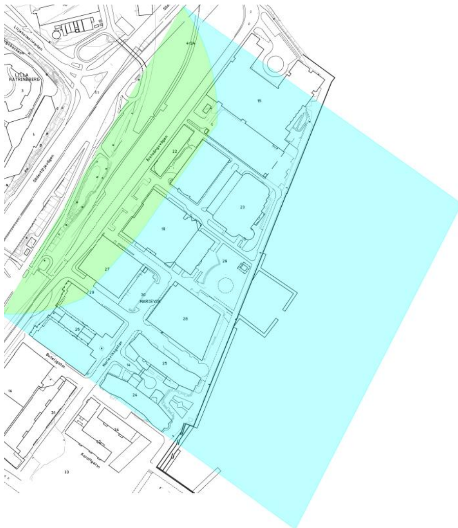
Figur 2 Markförhållanden, grön färg = fyllning på fast jord alternativt berg. Cyan färg = fyllning på lera.
