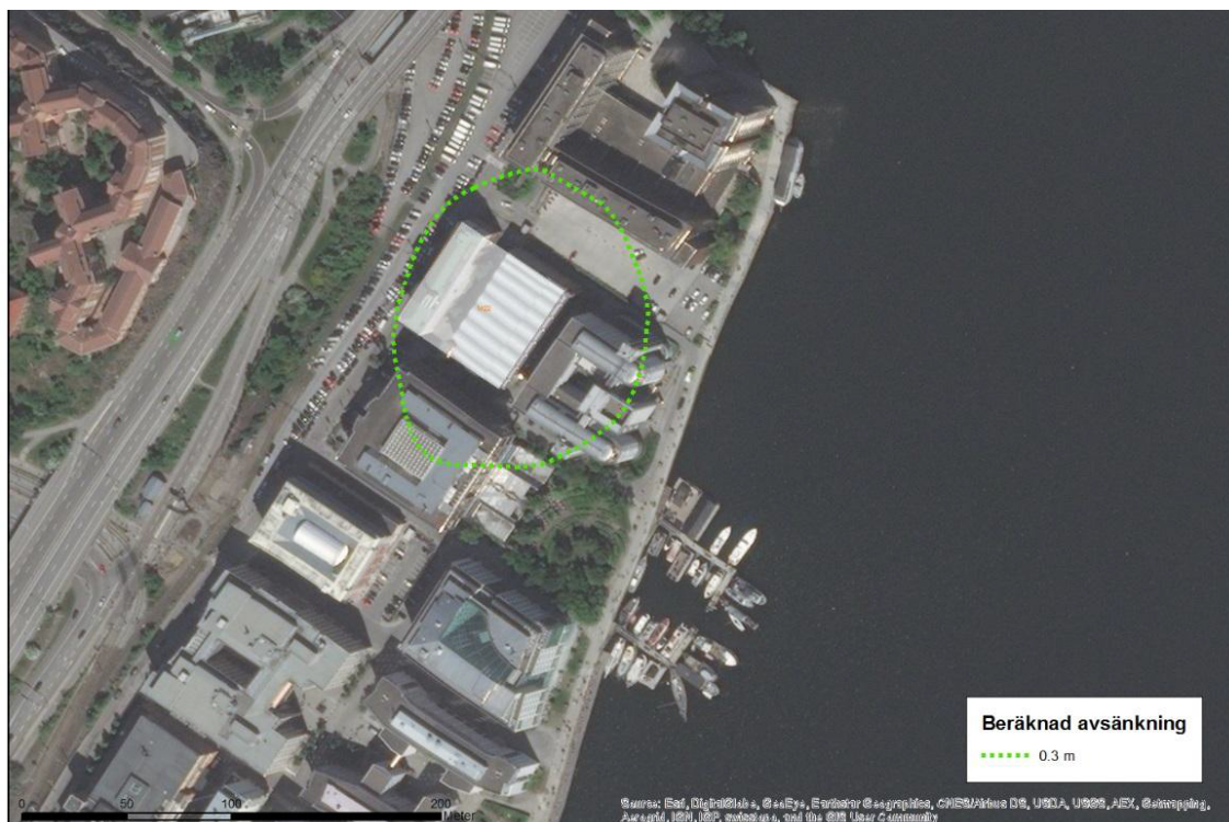
Figur 9. Beräknad grundvattenavsänkning vid tät spontkonstruktion. Källa: Bedömning om tillståndsplikt för grundvattenbortledning vid M22, Marievik, upprättad av Sweco Environnement.
