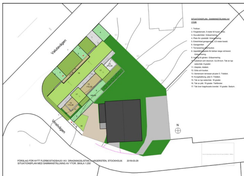
Figur 7. Planerad situation med indelning enligt tidigare för mörkgrönt område, takyta (befintlig byggnad), gårdspåsar (beige) samt indelning av ytor för det nya flerbostadshuset i nordväst. Ritunderlag från ZIN Arkitektur. Norr är uppåt i figur. Koordinatsystemet är i SWEREF99 18 00.
