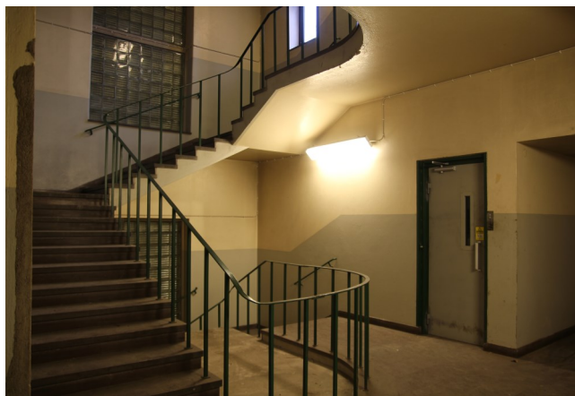
Bild 30: Trapphuset sett uppåt från bottenvåningen. Ursprungliga material i trappstegen av kalksten, smidesräcken liksom betongglas i fönstret.
