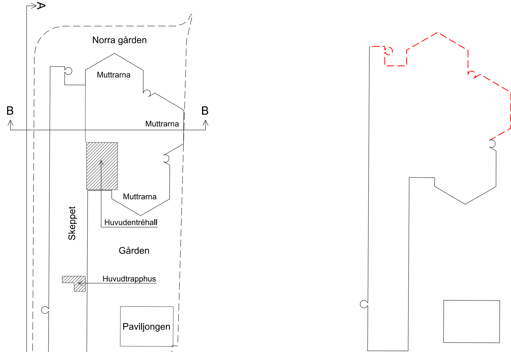
Principillustration 1 som visar namnen på planområdets olika byggnader och gårdsanläggningar. Lägen för rum som avses enligt bestämmelsen q5 samt fasadelevation A-A och sektion B-B skärning.
