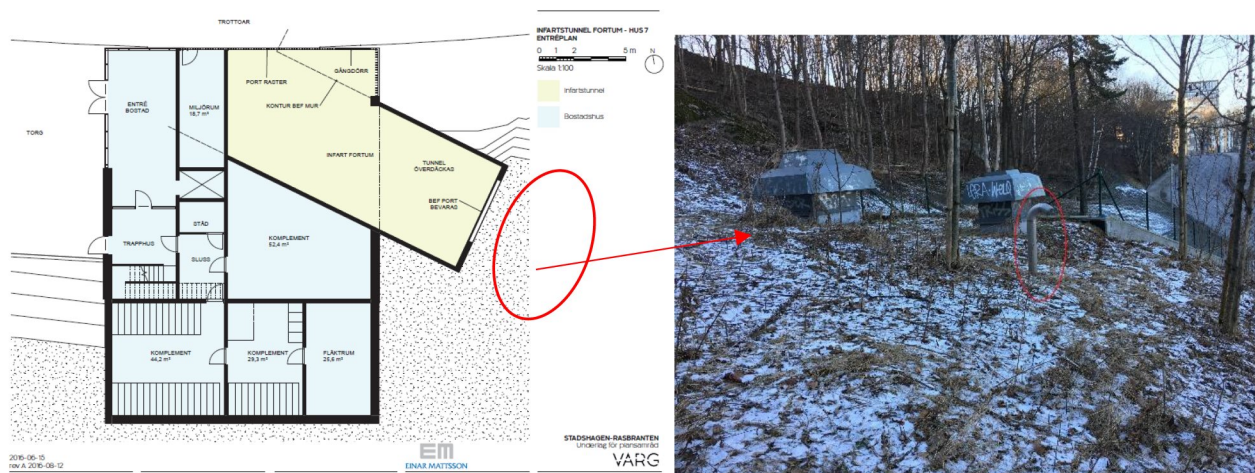
Figur 11. Till vänster; planerad nybyggnationen i förhållande till frånluft från bergumsanläggningen. Rödmarkerad där friskluftsintagets riktning är markerat med rött. Till höger; utblåsventil av köldmediet markerad i rött.
