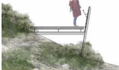
Stora Stadshagstrappan. Lätt konstruktion som följer terrängen med räcke i framkant mot utsikten.
