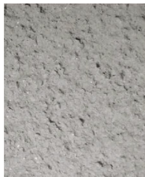
Puttsstruktur 8. Oorganisk ytputs, rivputs grov, kornmax 3 mm
