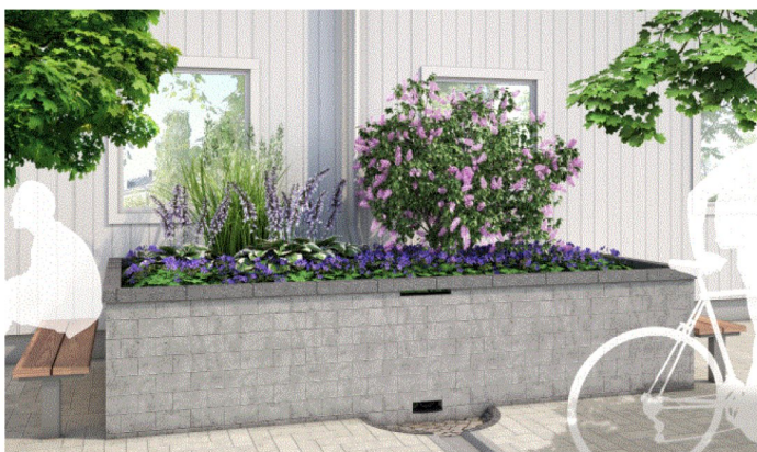
Figur 9. Regnbädd dit stuprör avvattnas.
