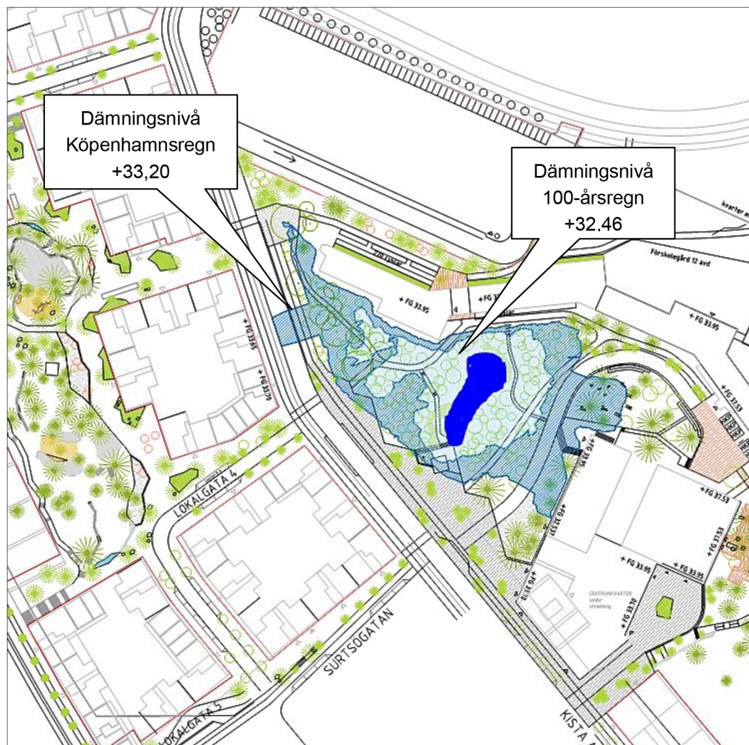
Figur 17. Utbredningen av dämningssnivåer för ett 100 årsregn med utlopp markerad med ljusblå skraffering och för ett Köpenhamnsregn med utlopp markerad med mörkblå skraffering.
