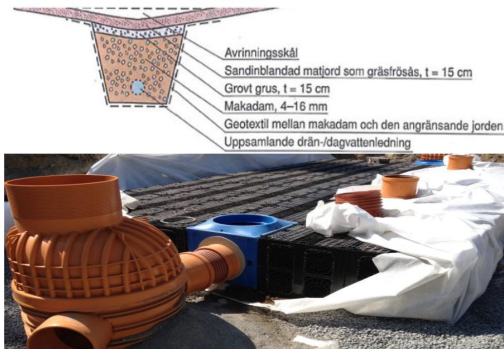
Figur 8 Över: Illustration över hur ett krossmagasin kan se ut (Svenskt Vatten, 2011). Under: Sammankopplade dagvattenkassetter (Svenska Bostäder, 2014)
