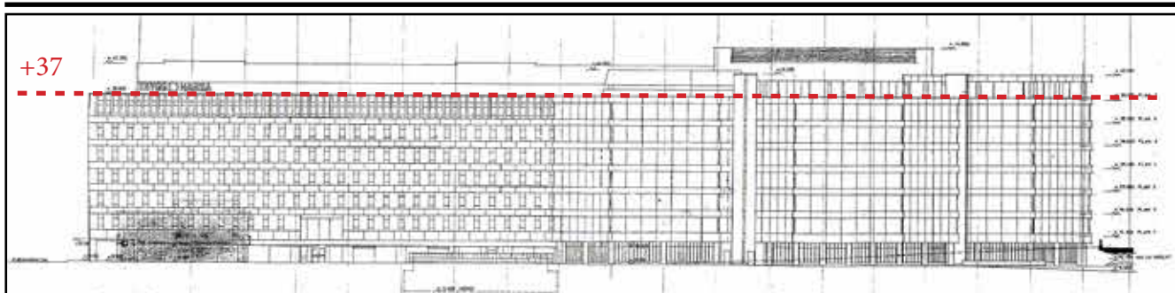
Ursprunglig fasadritning på befintlig byggnad som visar nivån +37 upp till vilken nya konstruktioner inte får synas i fasad.
