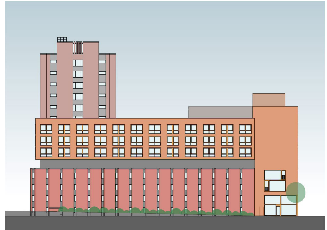
Fasader från söder. De två översta tillkommande volymerna är teknikutrymmen. Brunnberg & Forshed.
