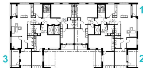
Figur 3 Balkonger på våning 1-6 som används för att minska bullernivån vid fasad.
