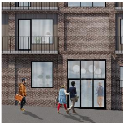
Fasaddetalj entrésituation. Entrén markeras med en utskjutande omfattning och tegelfyllningar i sockelvåningen.
