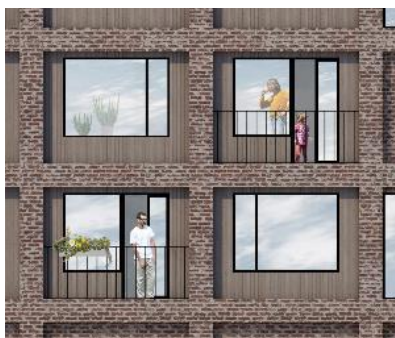
Fasaddetalj på det grova rutnätet av tegel med inskjutna träfyllningar. Breda franska balkonger.
