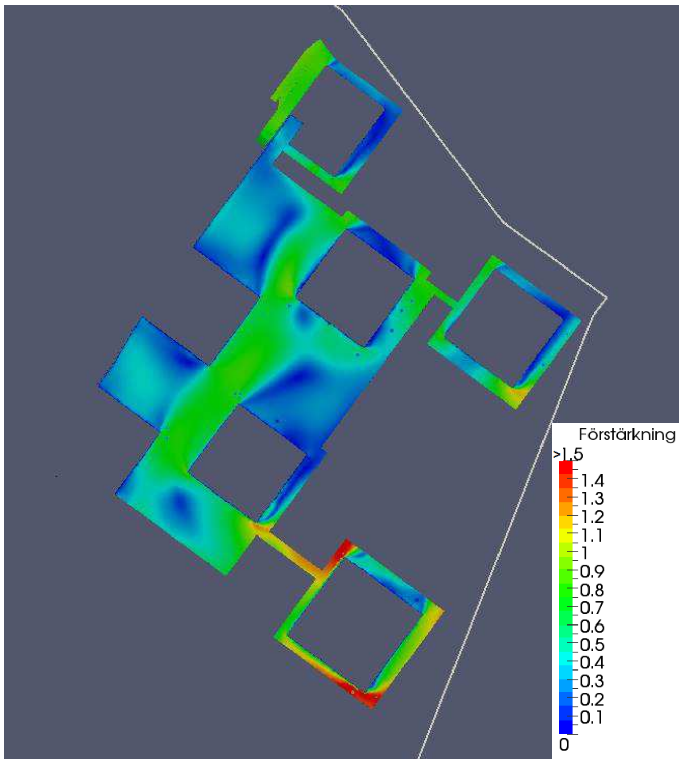
Figur B 23b. Vindens förstärkning vid vind från sydväst, 225°, på 2 m höjd över gårdar och gångbroar. Skalan anger förstärkningsfaktorn. Gulgrön färg (faktor 1) innebär att vinden upplevs lika stark som på ett öppet fält. Gul och röd färg innebär att vinden upplevs starkare och blå/grön färg att vinden upplevs svagare.
