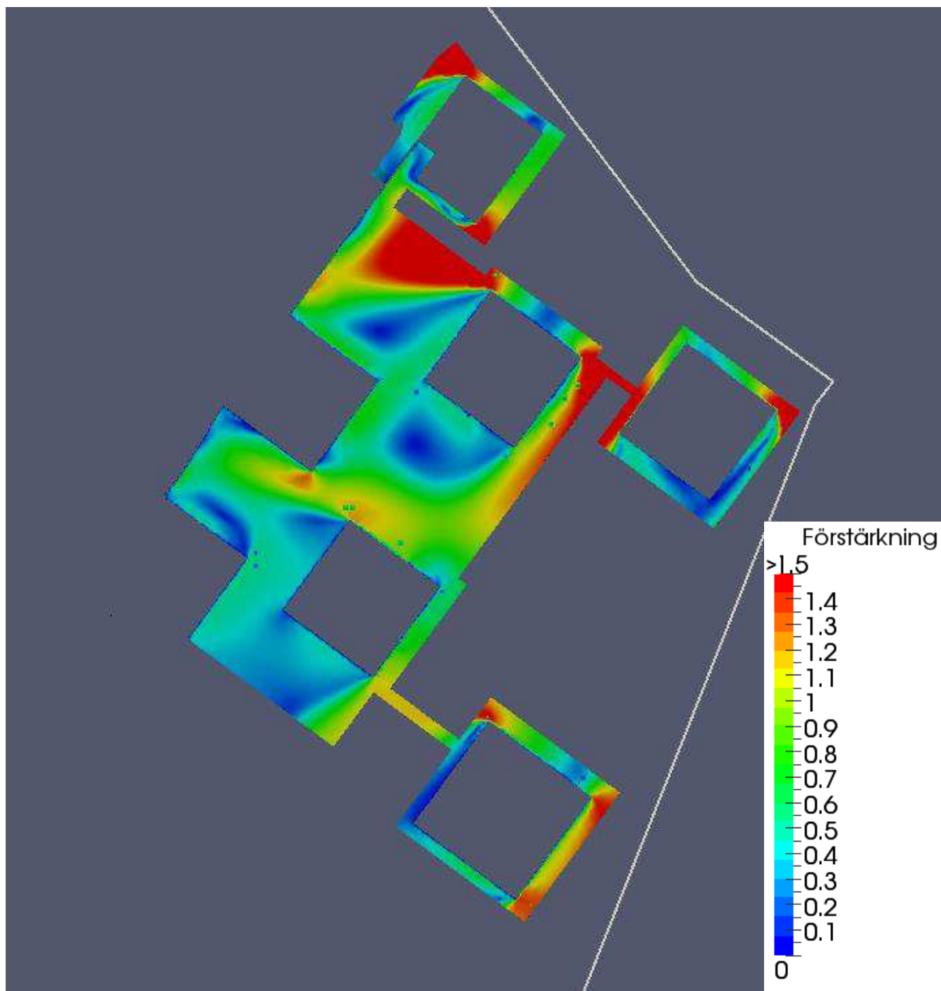
Figur B 19b. Vindens förstärkning vid vind från nordost, 45°, på 2 m höjd över gårdar och gångbroar. Skalan anger förstärkningsfaktorn. Gulgrön färg (faktor 1) innebär att vinden upplevs lika stark som på ett öppet fält. Gul och röd färg innebär att vinden upplevs starkare och blå/grön färg att vinden upplevs svagare.
