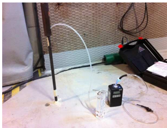
Figur 8: Uppställning med SKC-pumpar för lågflödemätning av porgas.
